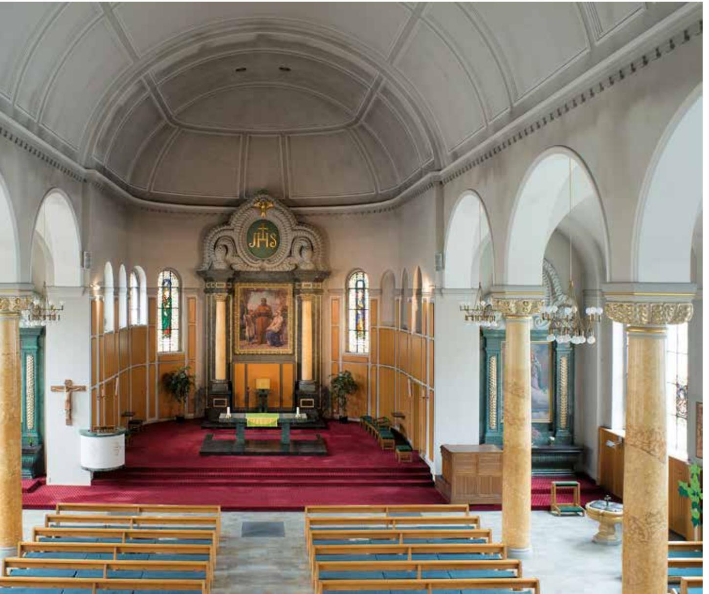
Kirchenraum in der Form einer Staffelhalle: Im Mittelschiff fehlt eine Fensterreihe, trotz des gegenüber den Seitenschiffen deutlich höheren gelegenen Gewölbescheitels.
