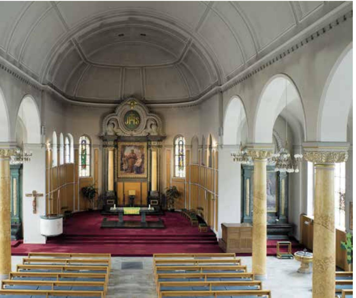
Kirchenraum in der Form einer Staffelhalle: Im Mittelschiff fehlt eine Fensterreihe, trotz des gegenüber den Seitenschiffen deutlich höher gelegenen Gewölbescheitels.
